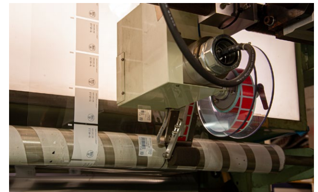
▲印刷柄検査装置で精度の高い検品を実現
