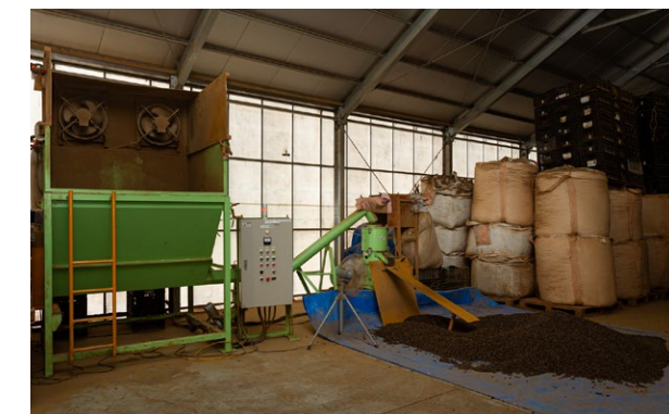
▲ペレット状に成型するペレット造粒システム
