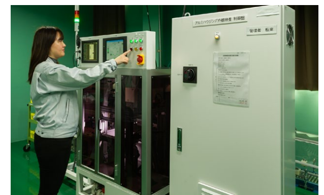
▲センサーケース外観検査システム画像処理機
