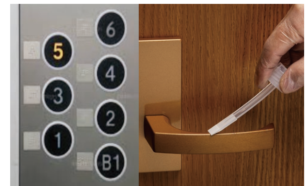
▲開発した微生物採取キット「バイオスワブ」での採取事例
