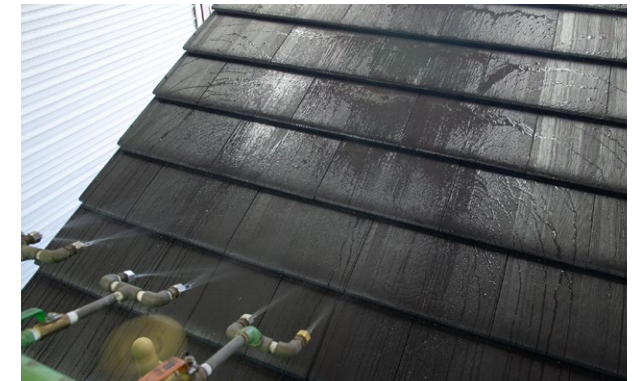
▲風圧・雨漏りの試験
